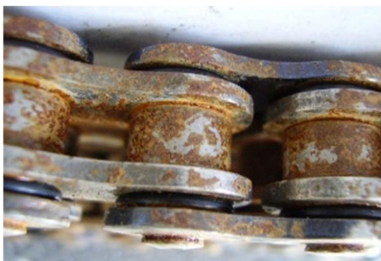
Obrázek 2: Takto zkorodovaný řetěz by měl být co nejdříve vyměněn, neboť hrozí destrukce řetězu.
