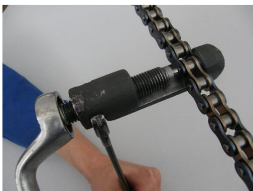
Obrázek 14: Montážní přípravek VZR 6 je vhodný na zkracování všech typů řetězů s roztečí 15,875 mm.
