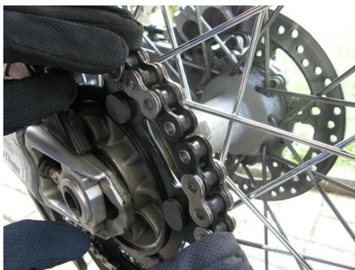
Obrázek 6: Pro měření délky řetězu i pro montáž spojovacího článku je vhodné konce řetězu umístit na řetězové kolo.
