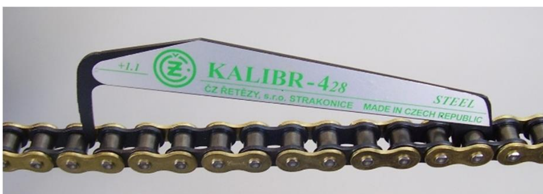
Obrázek 3: Měření stupně opotřebení řetězu kontrolní měrkou
