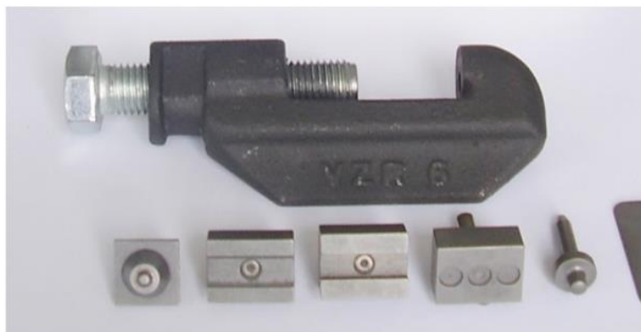
Obrázek 5: Montážní přípravky doporučené ke spojování a rozpojování řetězů ČZ
