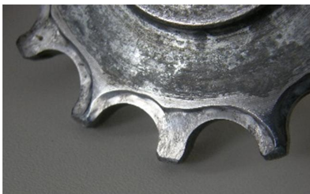
Obrázek 8: Opotřebované a zdeformované zuby řetězového kola je nepřijatelné užívat v kombinaci s novým řetězem.
