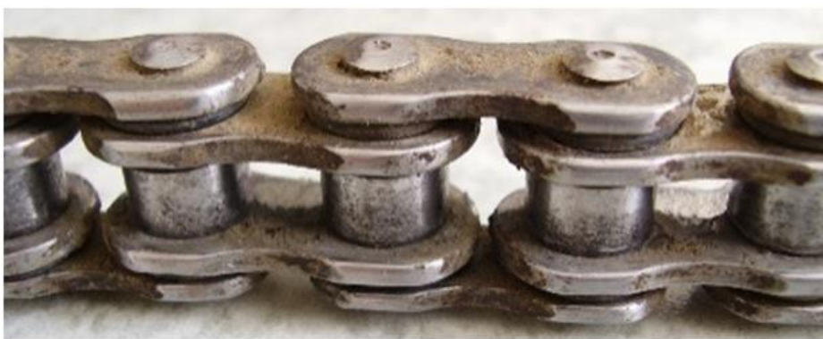
Obrázek 1: Nadměrně opotřebované destičky
