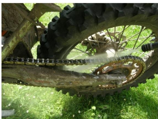
Obrázek 16: Silně zablácený netěsněný i těsněný řetěz je nejlepší a nejsnadnější vyčistit tlakovou myčkou se studenou vodou bez chemikálií.
